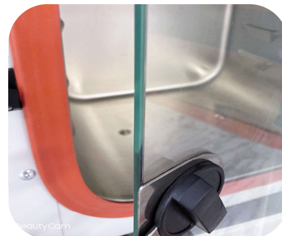
全景玻璃门：超大视野 ，全方位观察试验过程
