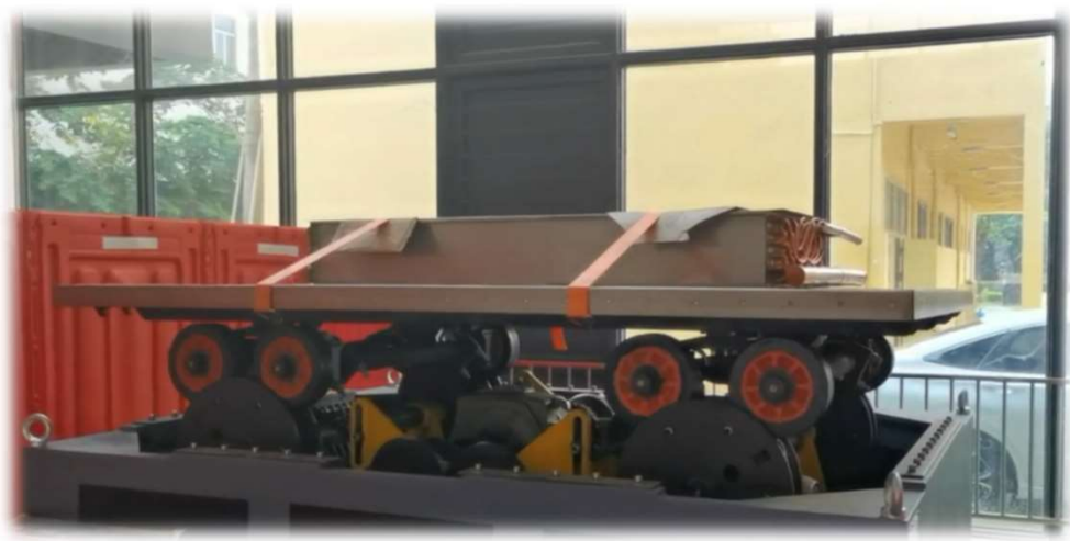
6、冷冻蒸发器安装前进行振动测试
