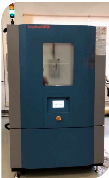
箱体正面有观察视窗、控制屏、 急停开关、超温保护、USB接口、 摄像机（选配）
