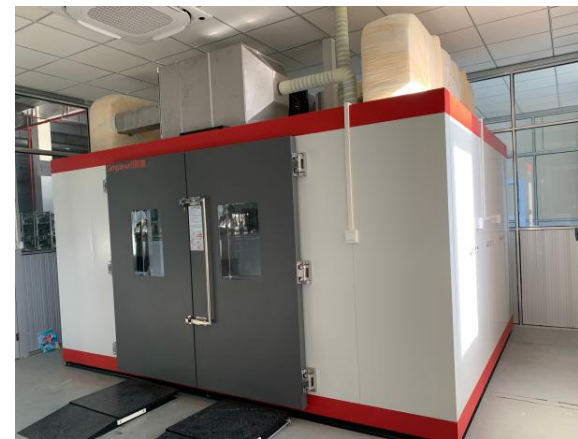
风道外置，风道等机组置于舱顶
